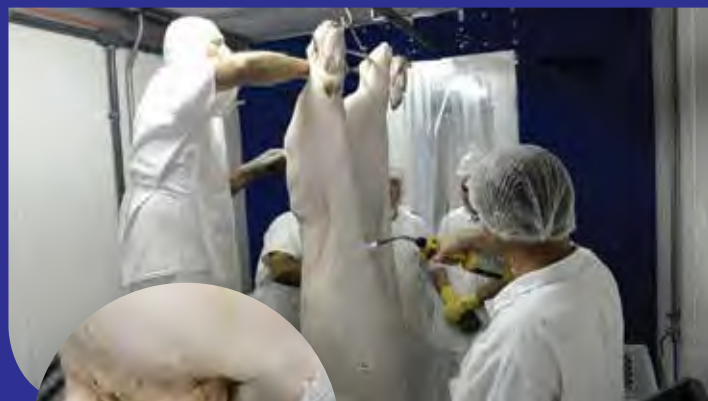
Ainda na área suja, toaleta (raspagem final dos pelos) com maçarico (detalhe) da carcaça para limpeza do que não saiu na depiladeira
