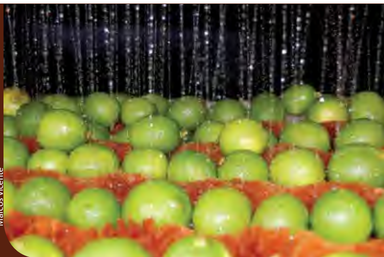
No novo modelo, o sistema de imersão das frutas é substituído por jatos d'água limpa
