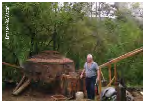
O sistema de condensação de fumaça modelo Brochier possui três câmaras, que resfria a fumaça
